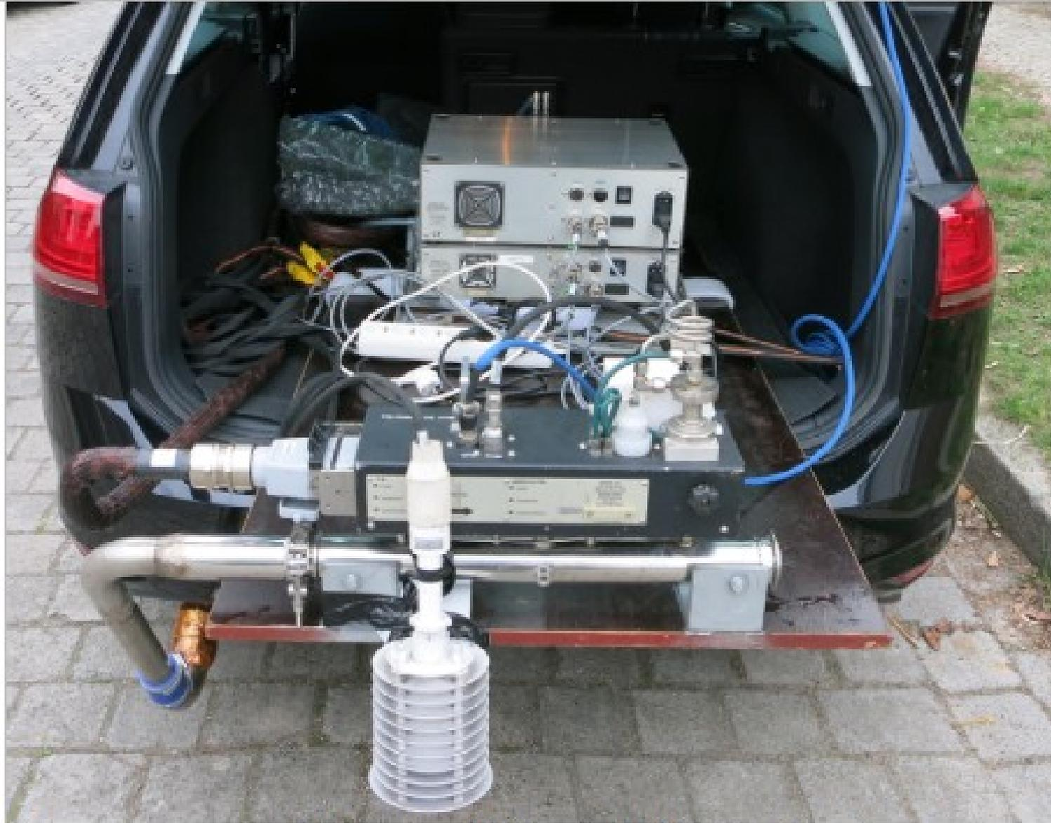
Abbildung 1: Messaufbau für die Messung von Stickstoffdioxid (NO<sub>2</sub>)
